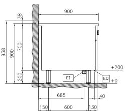
Electrical inlet (power) Equipotential screw ΕI EQ
